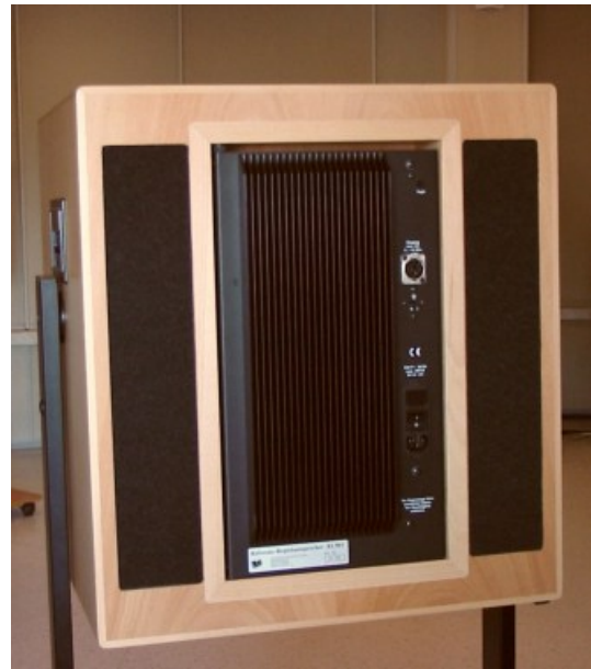
Kaum auffallend sind die mit akustischen Laufzeitgliedern abgeschlossenen Kammern rechts und links auf der Rückseite des RL901K
