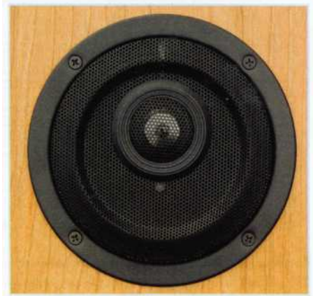
Erkennungsmerkmal und Markenzeichen aller Geithain-Lautsprecher ist ihr Koaxial-System: Die auffällige asymmetrische Anordnung des Hochtöners vor dem Tiefmitteltöner soll den Kammfilter-Effekt vermeiden helfen.
